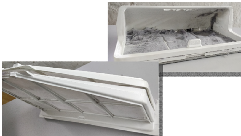
Abbildung 4: Verschmutzter Filter eines Kondenstrockners (eigene Fotos)
